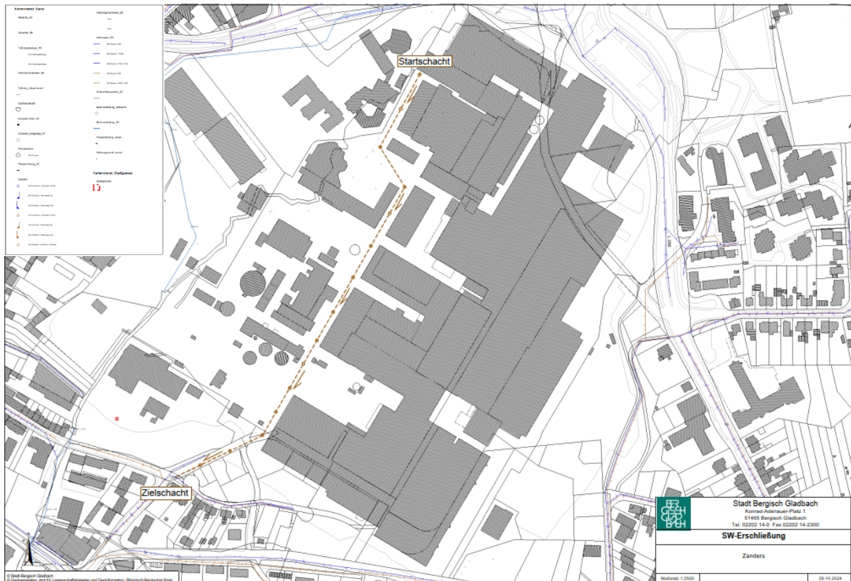
Abb. 1: Lageplan Schmutzwasser-Hauptsammler geplant
