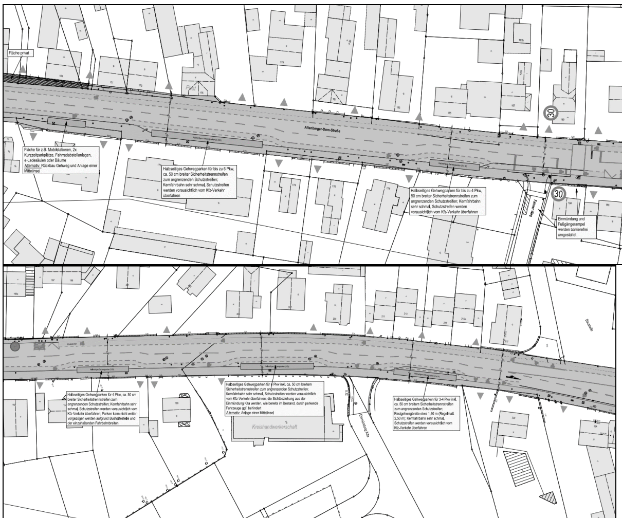
Abbildung 1 Ausbildung des halbseitigen Gehwegparkens und Schutzstreifens auf Höhe der alten Tankstelle an der Altenberger-Dom-Straße
