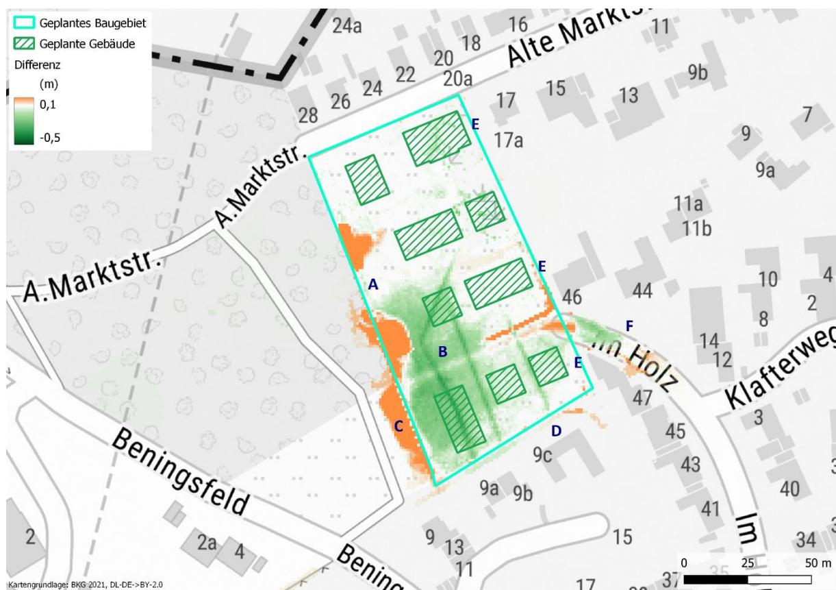
Abbildung 4-3: Differenz der maximalen Wassertiefen Planvariante 3 – Referenzzustand
