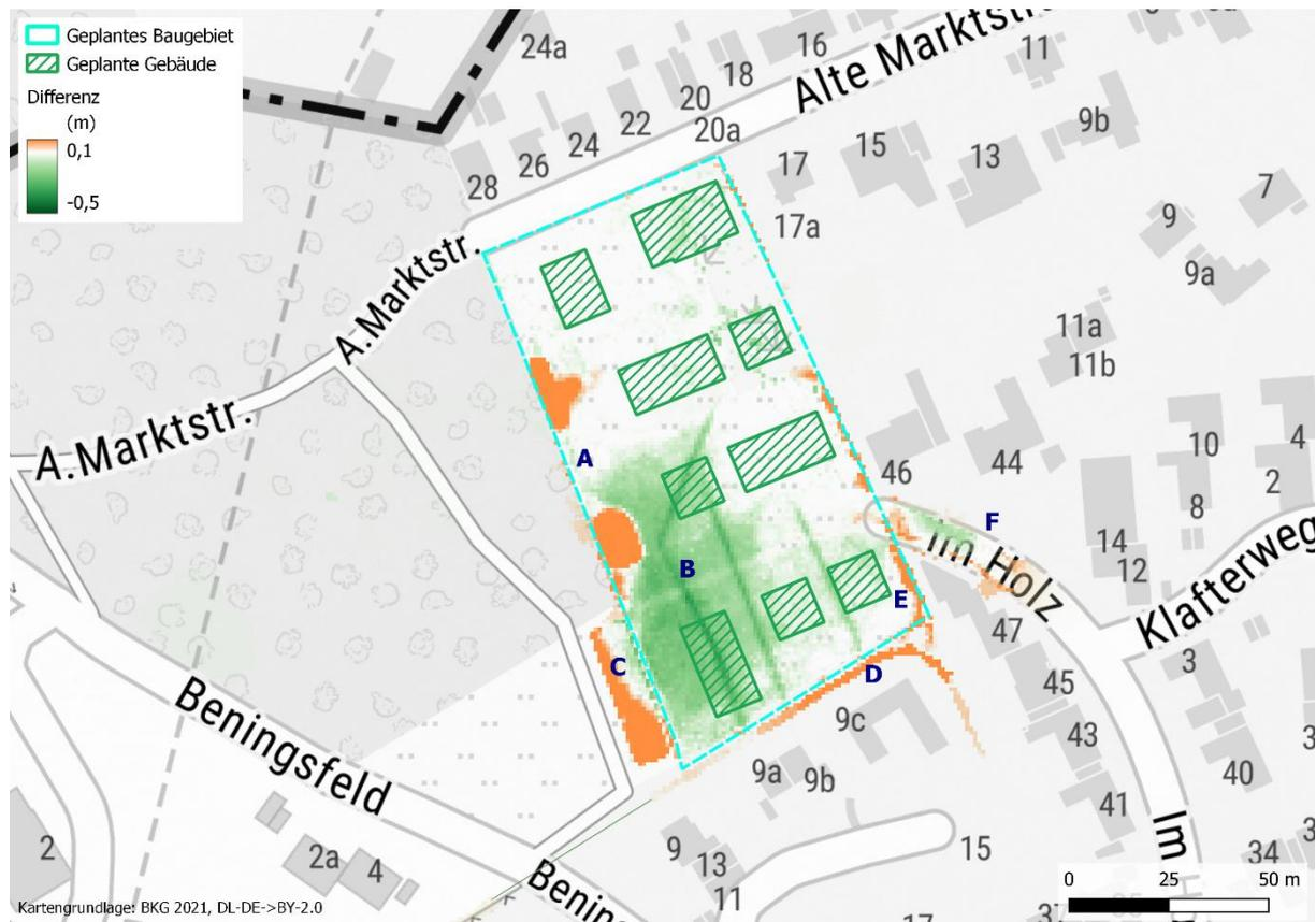
Abbildung 4-2: Differenz der maximalen Wassertiefen Planvariante 2 – Referenzzustand
