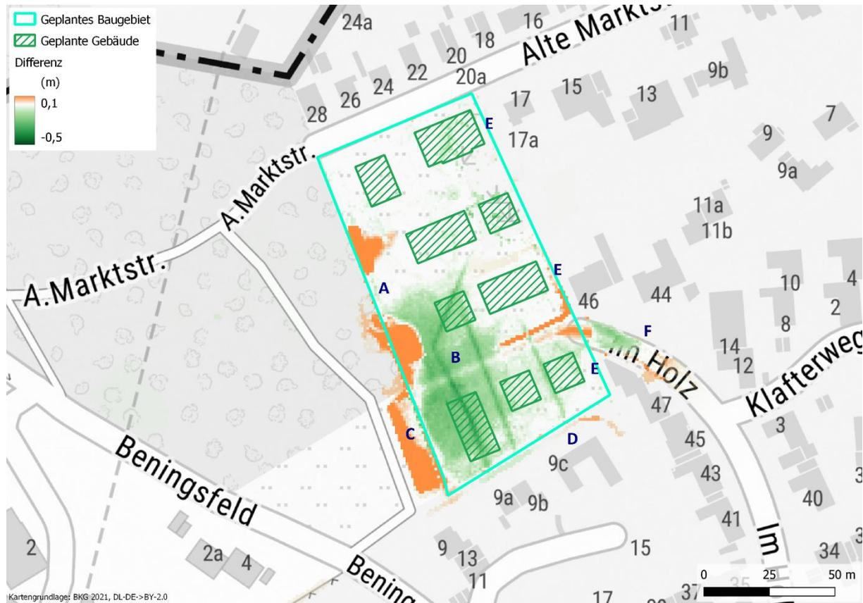
Abbildung 4-4: Differenz der maximalen Wassertiefen Planvariante 4 – Referenzzustand
