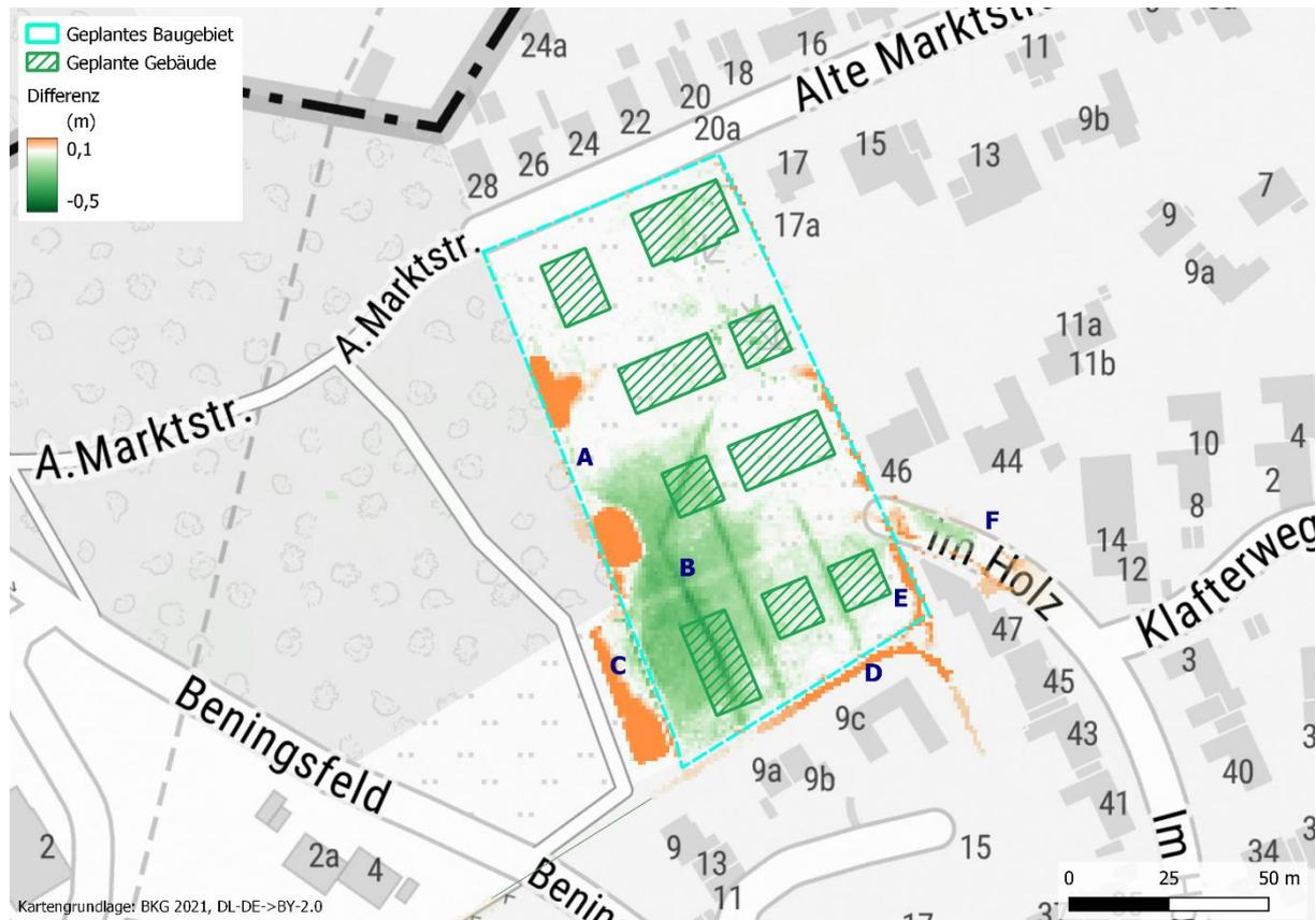
Abbildung 4-1: Differenz der maximalen Wassertiefen Planvariante 1 – Referenzzustand
