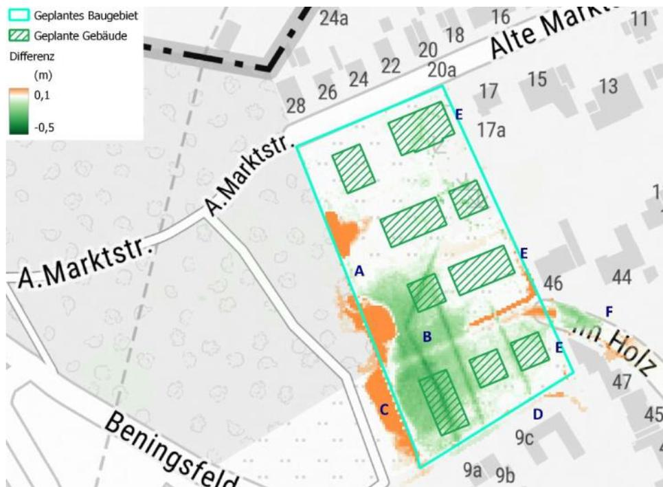
Quelle: Hydrotec GmbH 2022: Starkregennachweis: Planvariante 3 (100-jährliches Regenerereignis); oben: Starkregensimulation | unten: Differenz max. Wassertiefen – Referenzzustand
